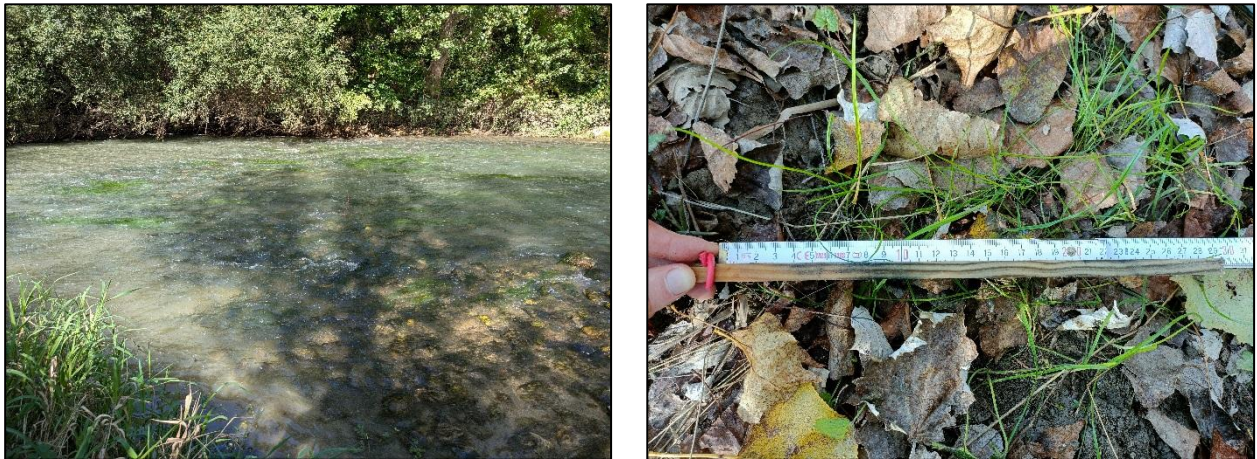
Figure 15 : Photographies de radier utilisé pour l'évaluation de la distribution granulométrique et du niveau de colmatage (à gauche) et d'un batonnet lors de la relève (à droite)
